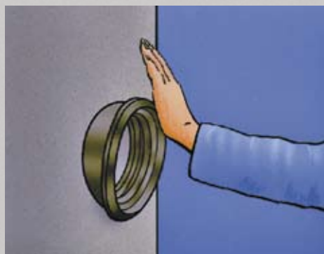
Press i Forsheda 910 i hullet.
